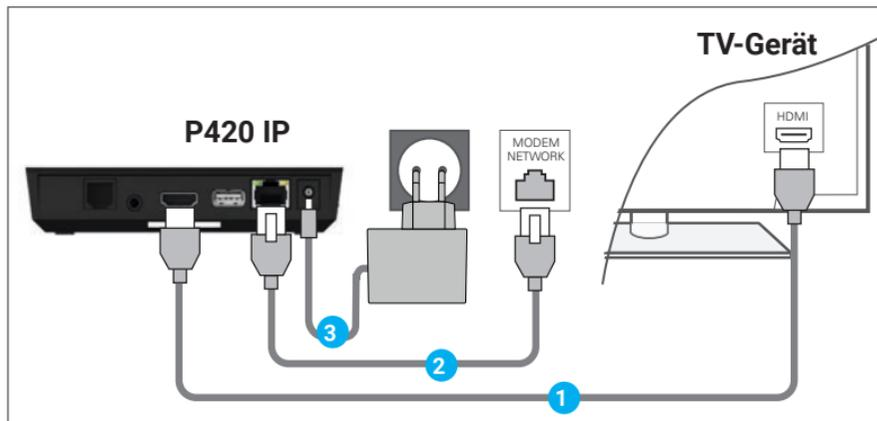
Abbildung 2: Kabelverbindungen
