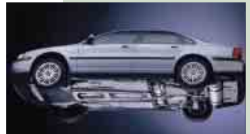
Unterflurtanks bei einem Volvo: Die Erdgasbehälter sind unter dem Fahrzeugboden angebracht und verringern so nicht den Stauraum
